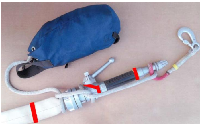
Kreuzklink und Schlag am Strahlrohr, z.B. zum Aufziehen in höhere Stockwerke
