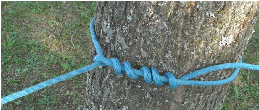
...z.B. zum Sichern an Bäumen (mind. 3 Windungen)
