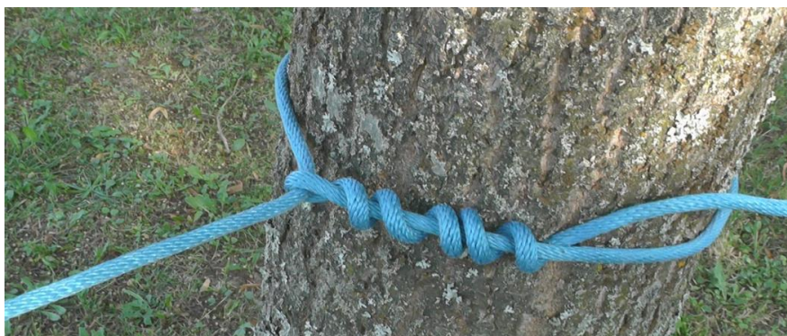
...z.B. zum Sichern an Bäumen (mind. 3 Windungen)
