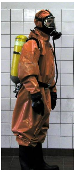
Vollschutzanzug mit schwerem Atemschutz, gasdicht
