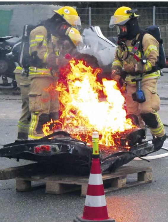
Löschtest an einer eher kleinen Fahrzeugbatterie: Vollständige Schutzausrüstung inklusive Atemschutz ist dabei Pflicht.
